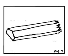
10. BEVEL THE FACE OF THE CROSS USING THE SMALL BEVEL FROM THE CUTS ON THE VERTICAL AS THE REFERENCE. NOTE: THE CUT BEVEL ON THE HORIZONTAL ARMS IS ON THE BACK SIDE. SO BEVEL THE FRONT ALONG THE CERTERLINE. CAUTION: DON'T BEVEL THE DIAMOND (TWISTED) AREA (CENTER OF THE CROSS).
